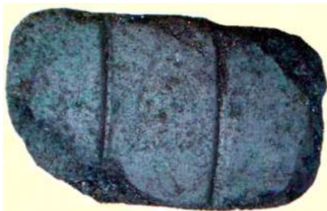
Fig. 4 – Briquette de charbon pour locomotive à vapeur, divisible en trois morceaux
